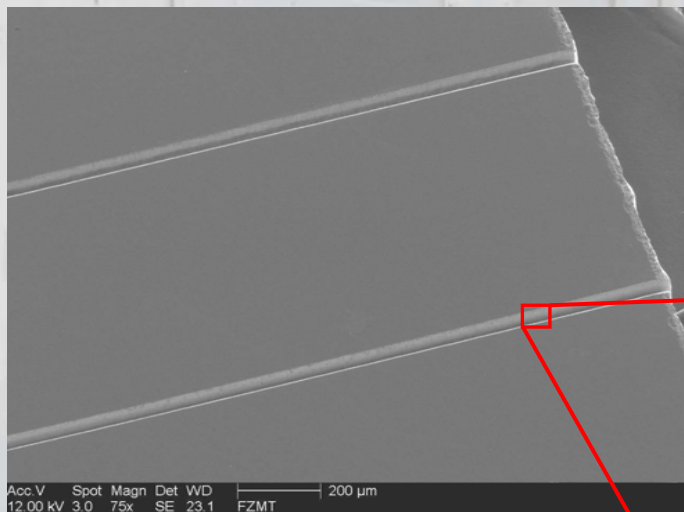
Schnitte in 3C-SiC, 30 \mu\text{m} breite
