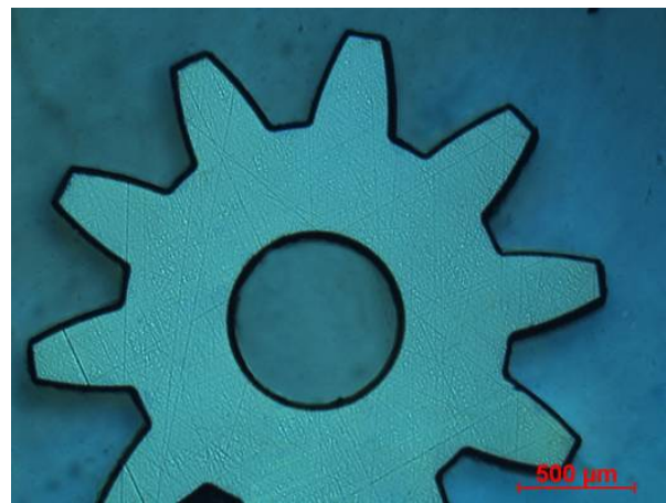
Abbildung 3. Zahnrad aus kubischem Siliziumkarbid Einkristall (3C-SiC)
