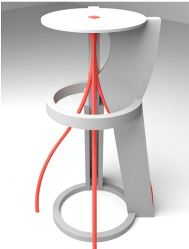
Design, Modell und Herstellung eines 3D 1x4 optischen Strahlteilers
